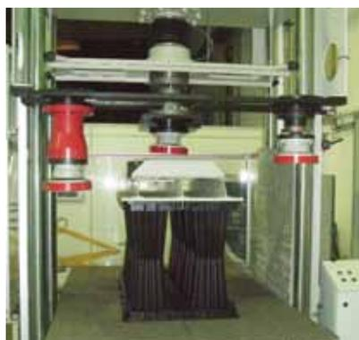
L'ACO Stormbrixx a été testé en toute indépendance afin de garantir la fiabilité de la construction à long terme. Le principe breveté \* du montage imbriqué, le 'Brick-bonding', garantit une installation très stable et facile à entretenir. En outre, le montage est rapide et facile.
