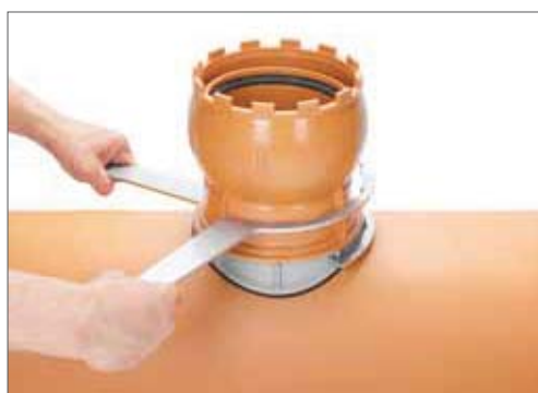
3. Visser la rotule avec bague de serrage sur la selle intérieure
